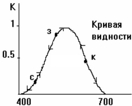
Рис. 48. График относительной спектральной световой эффективности излучения  $K(\lambda)$  (точки с, з и к соответствуют синему, зеленому и красному цветам).
