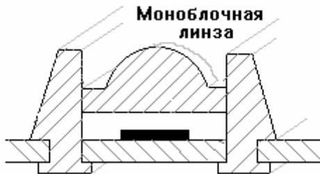
Рис. 51. Конструкция индикатора с моноблочной линзой.
