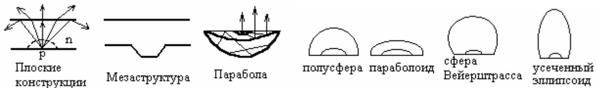
Рис. 7. Конструкции излучающих диодов.
