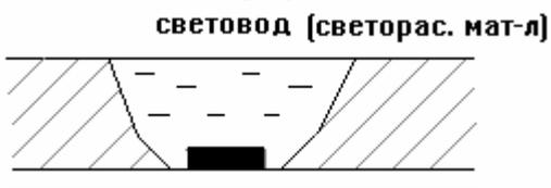
Рис. 52. Структура индикатора со светорассеивающим материалом.
